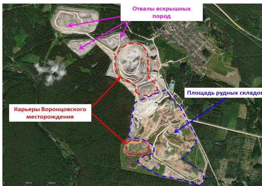
Рис. 3. Расположение ТМО горнодобывающего производства Воронцовского месторождения
